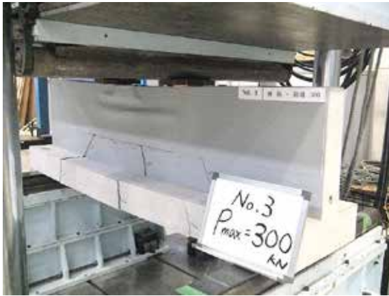
写真7 破壊状況（表側） 試験体記号：No.3 P_{max}=300 kN ・コンクリートの曲げ割れ及び圧壊
