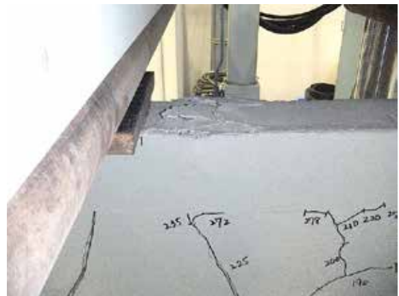
写真12 破壊状況（表側） 試験体記号：No.4 P_{max}=286 kN ・コンクリートの圧壊
