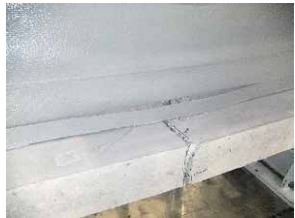
写真6 破壊状況（表側） 試験体記号：No.2 P_{max}=323 kN ・繊維シートの剥がれ
