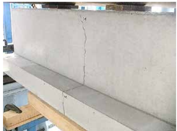
写真 18 破壊状況（裏側） 試験体記号：No.7 P_{max}=104 kN ・コンクリートの曲げ割れ
