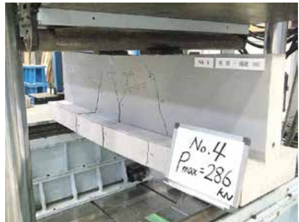
写真10 破壊状況（表側） 試験体記号：No.4 P_{max}=286 kN ・コンクリートの曲げ割れ及び圧壊
