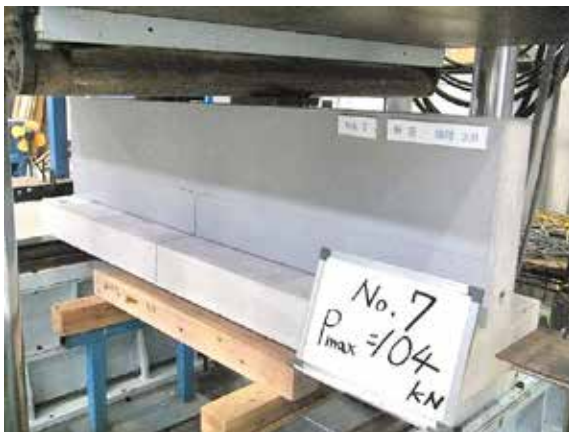
写真 17 破壊状況（表側） 試験体記号：No.7 P_{max}=104 kN ・コンクリートの曲げ割れ
