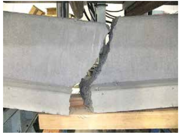
写真 14 破壊状況（裏側） 試験体記号：No.5 P_{max}=125 kN ・コンクリートの曲げ割れ
