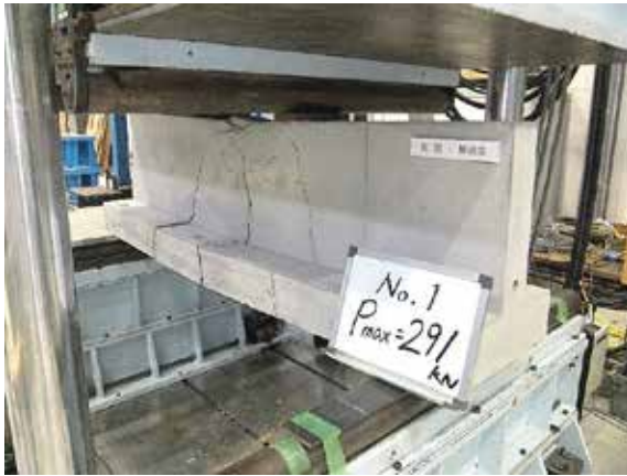
写真1 破壊状況（表側） 試験体記号：No.1 P_{max}=291 kN ・コンクリートの曲げ割れ及び圧壊
