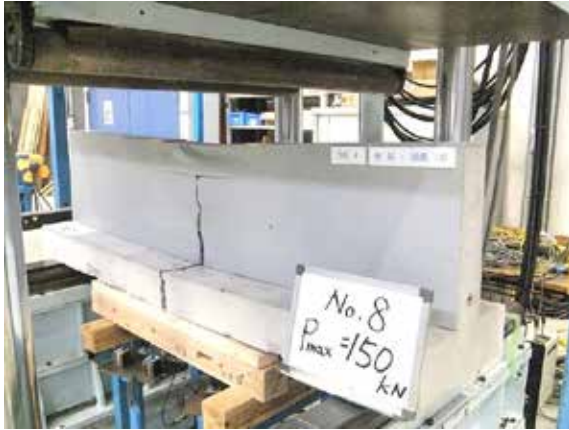
写真 19 破壊状況（表側） 試験体記号：No.8 P_{max}=150 kN ・コンクリートの曲げ割れ
