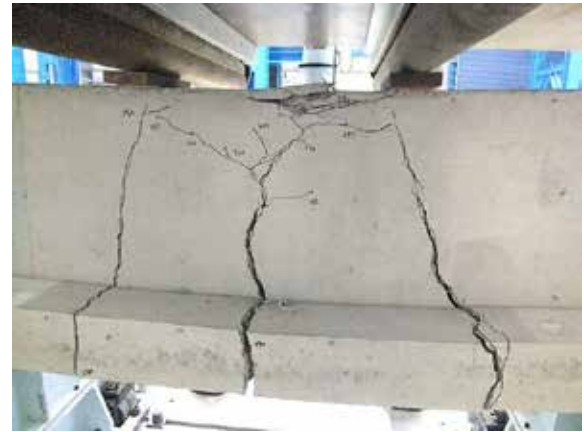
写真2 破壊状況（裏側） 試験体記号：No.1 P_{max}=291 kN ・コンクリートの曲げ割れ及び圧壊
