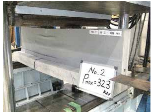
写真4 破壊状況（表側） 試験体記号：No.2 P_{max}=323 kN ・コンクリートの曲げ割れ及び圧壊
