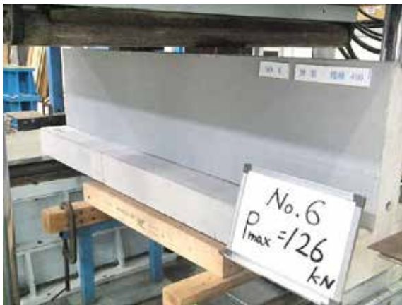
写真 15 破壊状況（表側） 試験体記号：No.6 P_{max}=126 kN ・コンクリートの曲げ割れ
