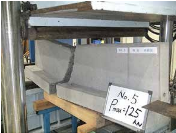
写真 13 破壊状況（表側） 試験体記号：No.5 P_{max}=125 kN ・コンクリートの曲げ割れ
