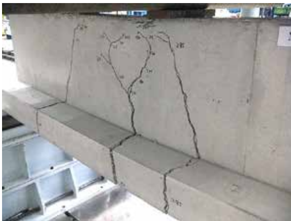
写真11 破壊状況（裏側） 試験体記号：No.4 P_{max}=286 kN ・コンクリートの曲げ割れ及び圧壊
